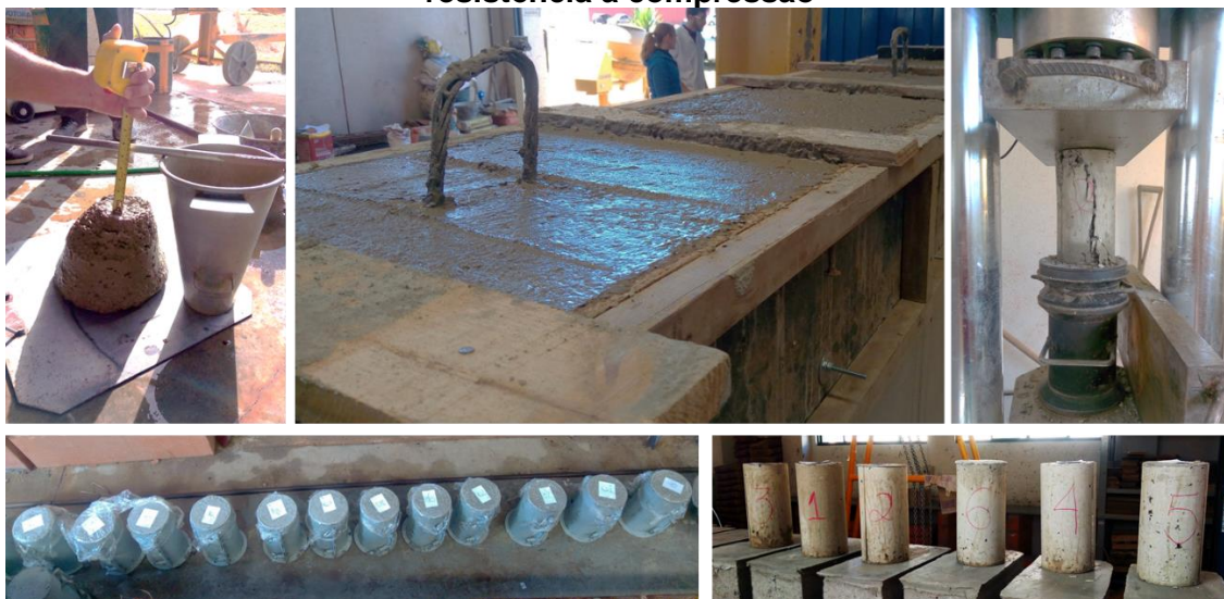
Figura 3.23: Slump test, etapa de concretagem e corpos de prova para teste de resistência à compressão
