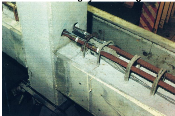
Figura 2.2: Montagem do ensaio de ligação semirrígida em esquema cruciforme
