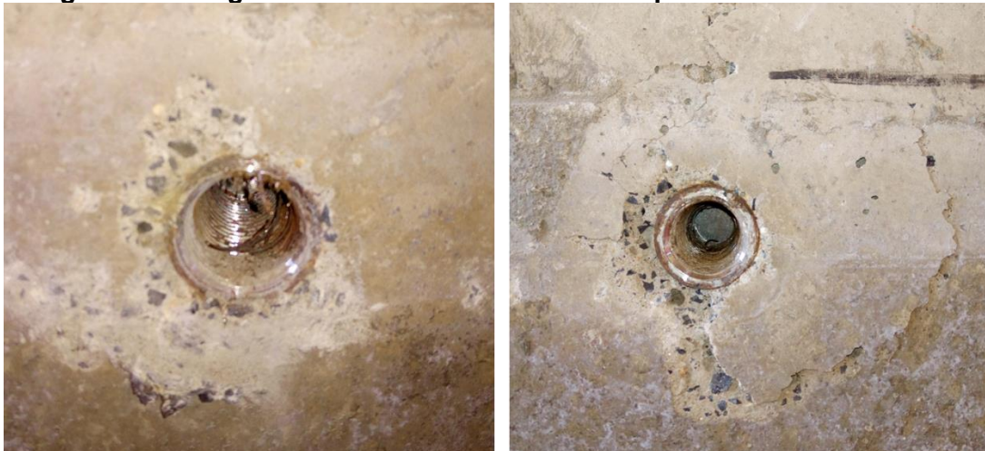
Figura 4.13: Região interna e externa das luvas após o término do ensaio
