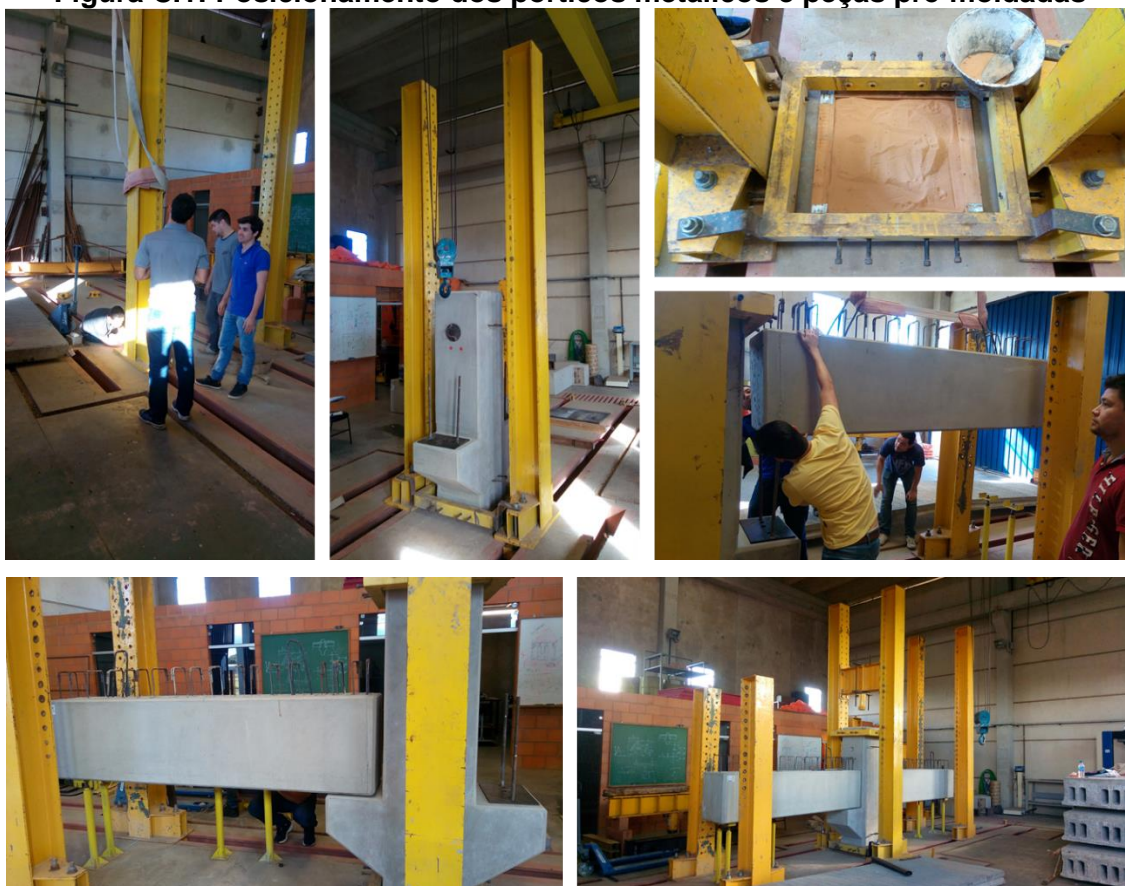
Figura C.1: Posicionamento dos pórticos metálicos e peças pré-moldadas
