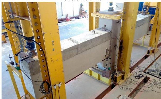
Figura 1.3: Ensaio de ligação viga-pilar em escala real – protótipo em arranjo cruciforme
