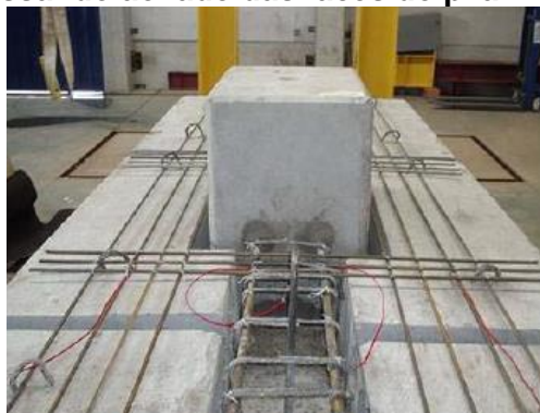
Figura 2.3: Ensaio de ligação viga-pilar com armadura de continuidade e armadura passando ao lado das faces do pilar na capa da laje
