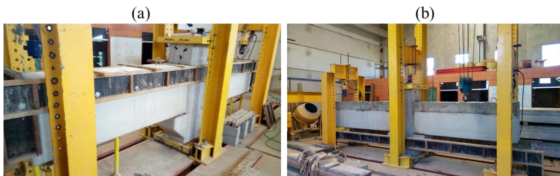
Figura C.11: (a) Cura da concretagem de segunda etapa (b) Retirada das fôrmas do Modelo 2 inteiramente montado
