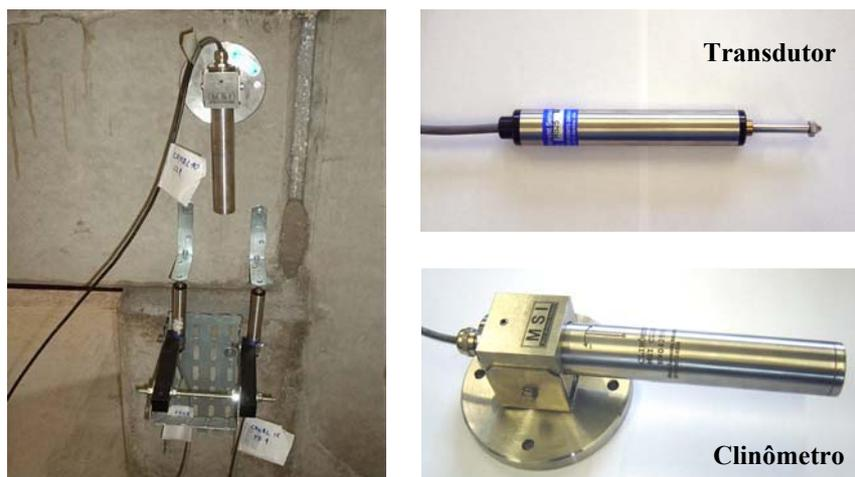
**Figura 3.27: Transdutor utilizado para medir deslocamentos e Clinômetro para medir rotação.**
