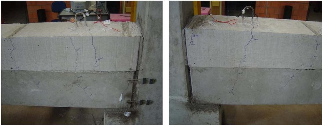
**Figura 5.4: Traçado das fissuras que surgiram no Modelo 1.**
