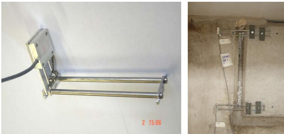
Figura 3.29: Extensômetro de base removível (EBR).
