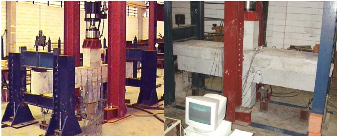
**Figura 2.24: Arranjos de ensaios com aplicação de carga no pilar e reações nas extremidades das vigas, empregados em FERREIRA (1999) e MIOTTO (2002).**
