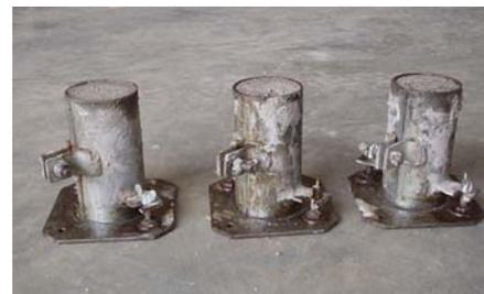
**Figura 3.24: Corpos-de-prova do graute.**
