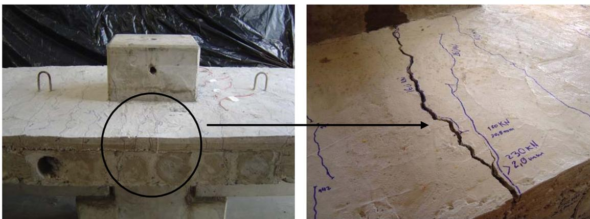
Figura 5.7: Fissuras no Modelo 2.
