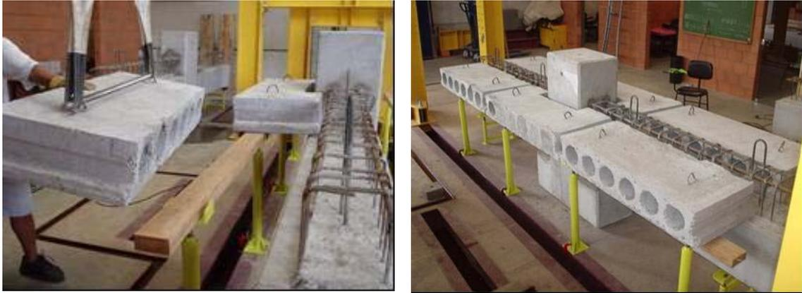
**Figura 3.17: Posicionamento dos elementos pré-moldados que compõem o Modelo 2.**
