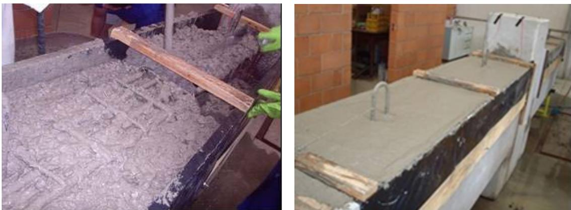
Figura 3.15: Concretagem do Modelo 1.
