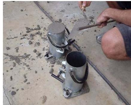
**Figura 3.23: Moldagem dos corpos-de-prova do concreto.**
