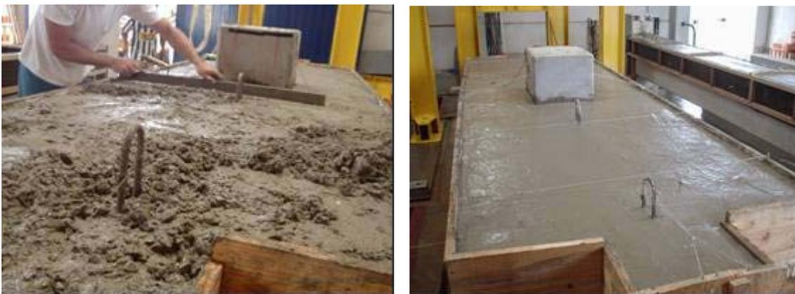
**Figura 3.22: Finalização da concretagem do Modelo 2.**
