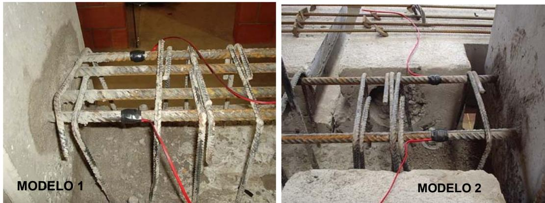
Figura 3.28: *Strain-gages* utilizados para medir deformação da armadura.
