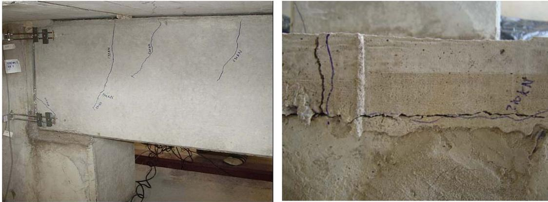
**Figura 5.8: Fissuração nas vigas e na interface entre a laje alveolar e a capa do Modelo 2.**
