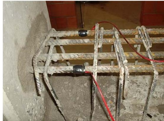
**Figura 3.12: Preparação das barras para colagem dos *strain-gages*.**
