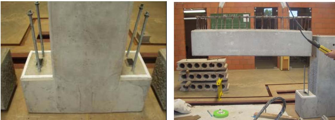
**Figura 3.10: Chapa metálica fixada ao consolo no local de giro da ligação e montagem das vigas.**
