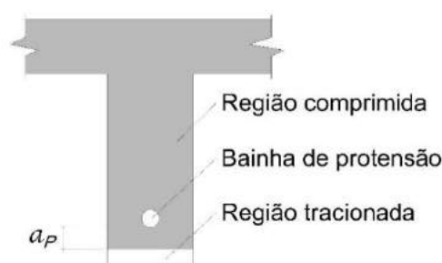
Figura 5: Estado limite de descompressão parcial
