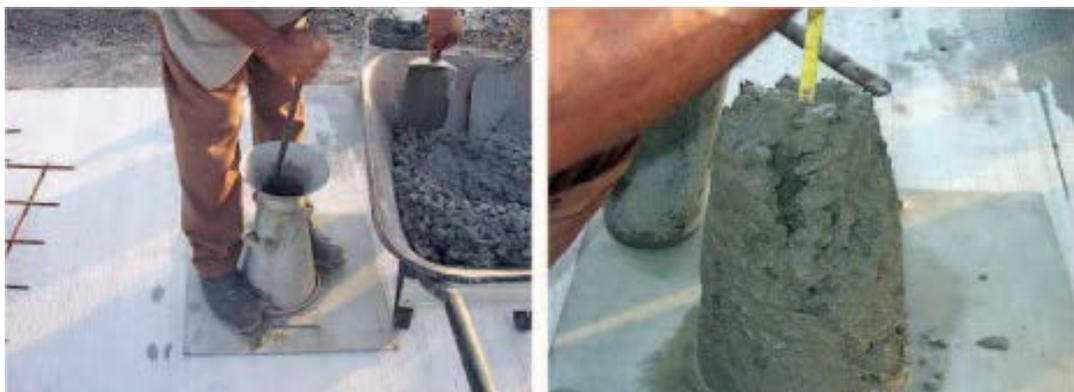
Figura 55 – Ensaio pelo método do abatimento do tronco de cone, para medir a consistência do concreto fresco (Fonte: Helene, 2005)
