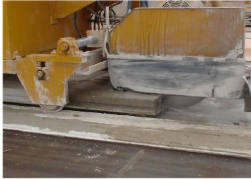
Figura 14 – Corte longitudinal de LACP (Fonte: Petrucelli, 2009)
