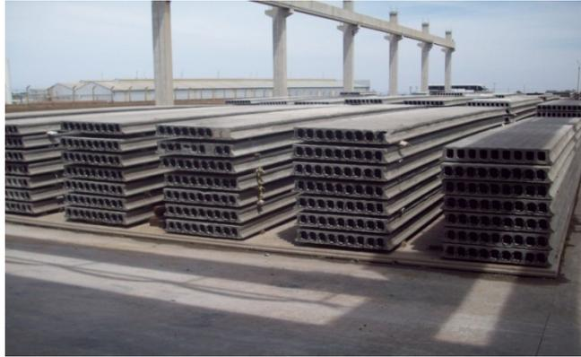
Figura 16 – Estocagem dos painéis com os calços alinhados (Fonte: Direitinho, 2014)
