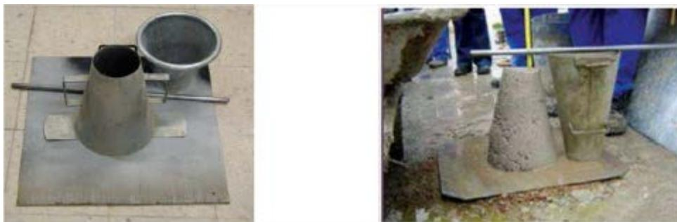
Figura 57 – Ensaio de abaixamento do cone de Abrams (Fonte: Cunha, 2011 apud Gomes e Pinto, 2008/2009)
