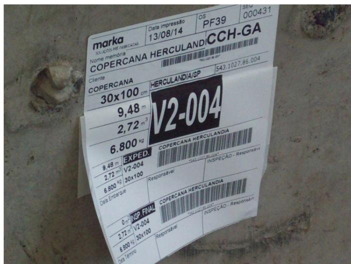
Figura 69– Etiquetagem/rastreamento interno dos produtos na fábrica visitada (Fonte: Direitinho, 2014)
