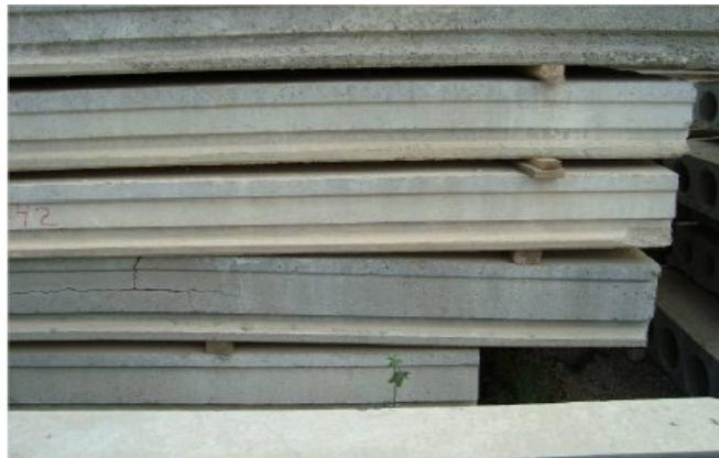
Figura 17 – Painéis fissurados devido a estocagem com calços desalinhados (Fonte: Petrucelli, 2009)
