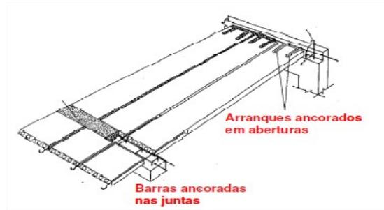
Figura 32 – Ligações laje/viga e laje/laje em LACP sem capa estrutural (Fonte: Elliott, 2005)
