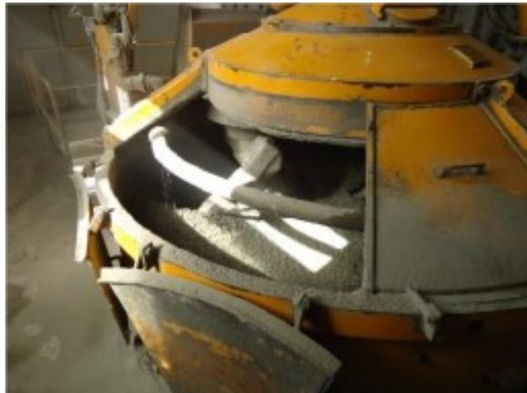
Figura 53 – Betoneira misturadora de central produtora de concreto usinado (Fonte: Cunha, 2011)
