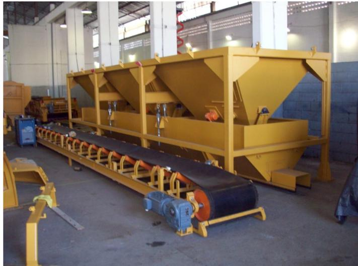
Figura 65– Esteira rolante e baias de alimentação da central de usinagem
