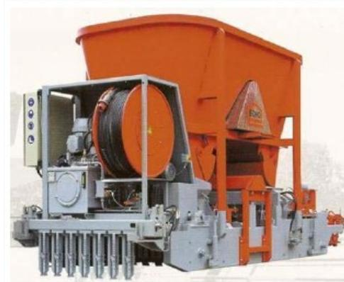
Figura 2 – Máquina utilizada no processo por forma deslizante (Fonte: Echo, 2014)
