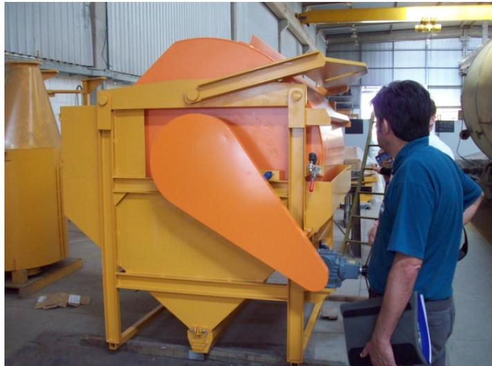
Figura 66– Caçamba de alimentação de extrusora/moldadora (Fonte: Direitinho, 2014)
