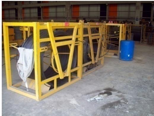
Figura 47 – Aço de protensão em bobines (Fonte: Direitinho, 2014)
