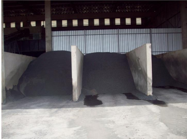
Figura 44 – Armazenamento/estocagem de agregados graúdos (Fonte: Direitinho, 2014)
