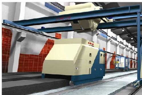
Figura 10 – Caçamba alimentando extrusora em produção contínua (Fonte: Elematic, 2007)
