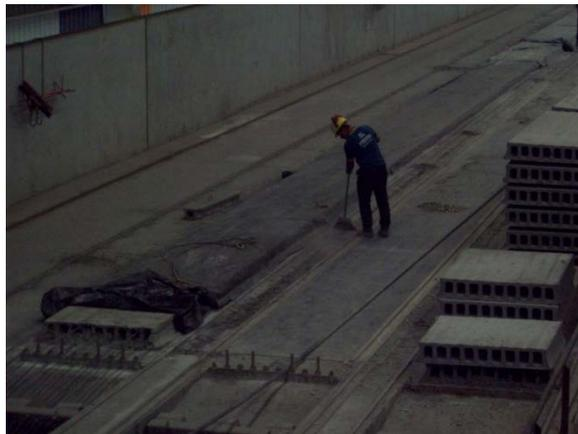
Figura 7 – Limpeza da pista de protensão (Fonte: Direitinho, 2014)
