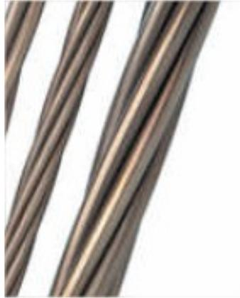
Figura 48 – Cordoalhas de três e sete fios para protensão (Fonte: Fernandes 2007, *apud* ARCELOR-MITTAL 2007)
