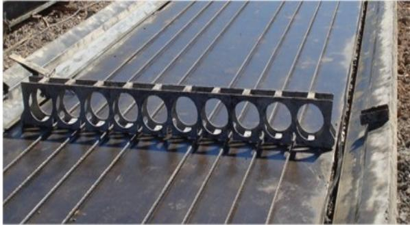
Figura 23 – Desmoldante, formas laterais, moldes e guias (Fonte: Direitinho, 2014)
