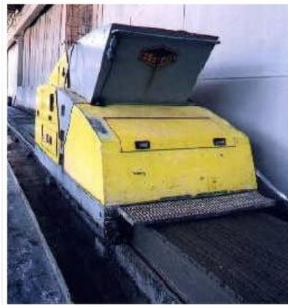
Figura 3 – Máquina utilizada no processo por extrusão (Fonte: Fernandes, 2007)
