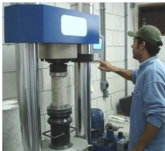
Figura 60 – Ensaio de ruptura à compressão (Fonte: Direitinho, 2014)
