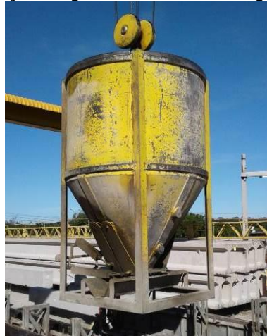
Figura 5-26: Caçamba para auxílio do transporte de concreto
