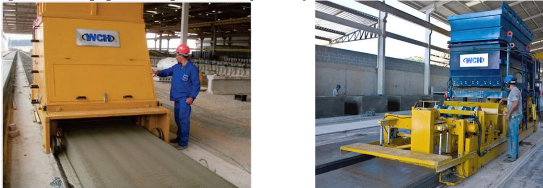
Figura 5-23: Equipamentos para fabricação de laje alveolar: a) extrusora b) moldadora
