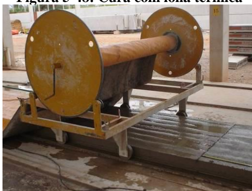
Figura 5-48: Cura com lona térmica
