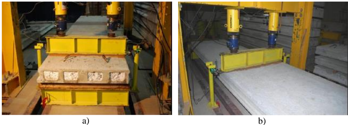
Figura 2-21: a) Determinação da resistência à força cortante; b) Determinação da resistência à flexão
