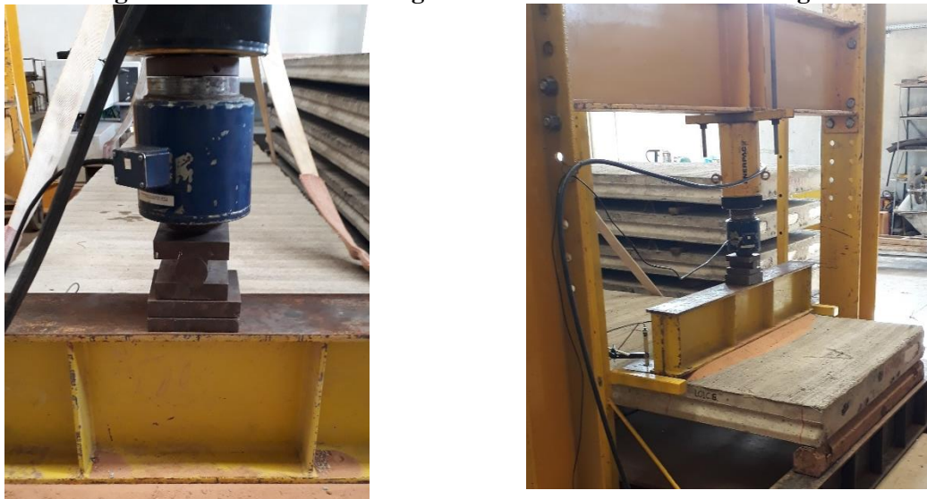
Figura 6-4: Rótula entre a viga de transmissão e a célula de carga
