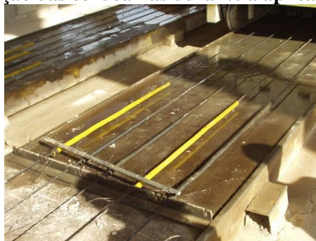
Figura 5-15: Proteção das cordoalhas durante a aplicação do desmoldante
