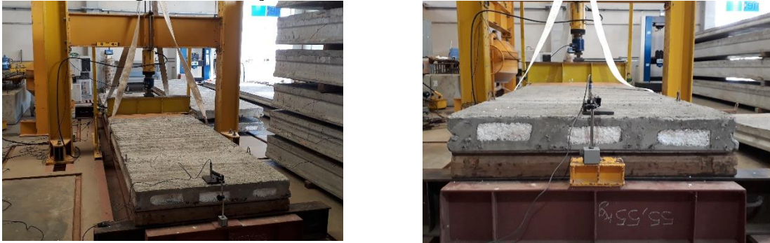
Figura 6-7: Posição dos transdutores sobre cada extremidade
