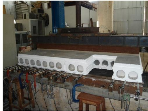
Modelo montado para ensaio
