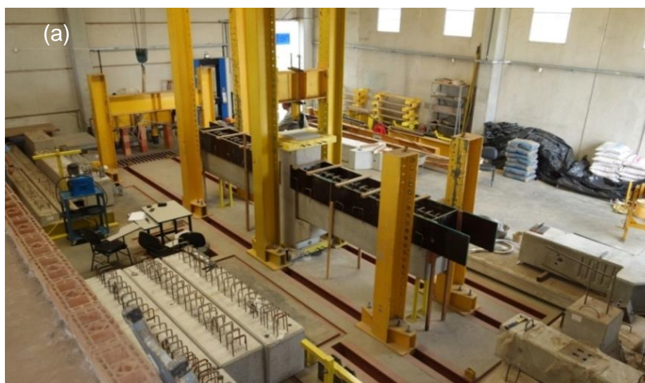
FIGURA 4.9 – Modelo NC (a) durante a montagem e (b) instrumentado para o ensaio
