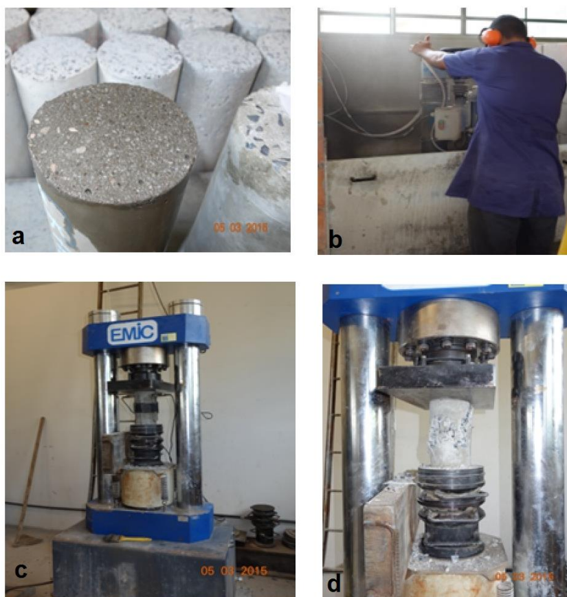
FIGURA 3.21 – Retificação das faces paralelas e ensaios de compressão axial e módulo de elasticidade dos corpos de prova
