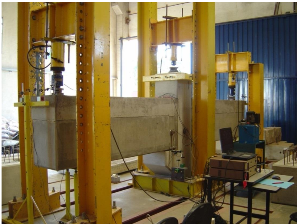
FIGURA 3.37 – Face 1 – sistema de aquisição de dados, computador, atuadores, células de carga, transdutores e clinômetros
