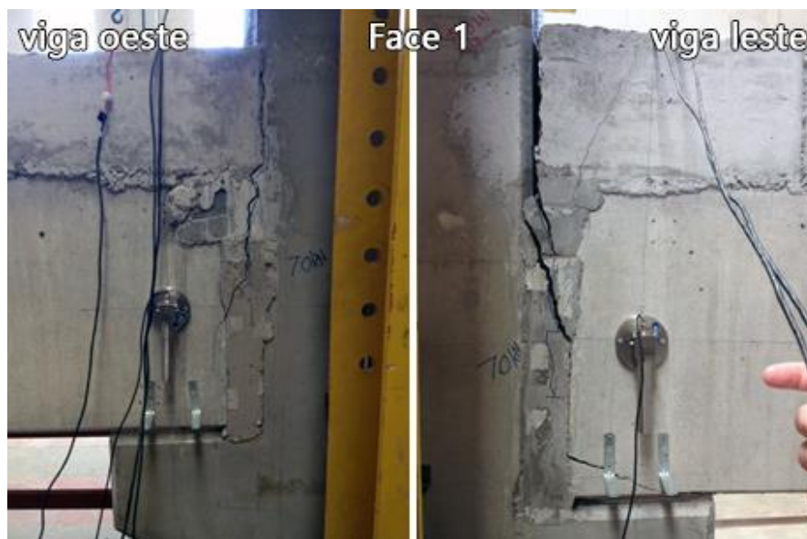
FIGURA 4.24 – Modelo GCE deformado, após o ensaio de flexão
