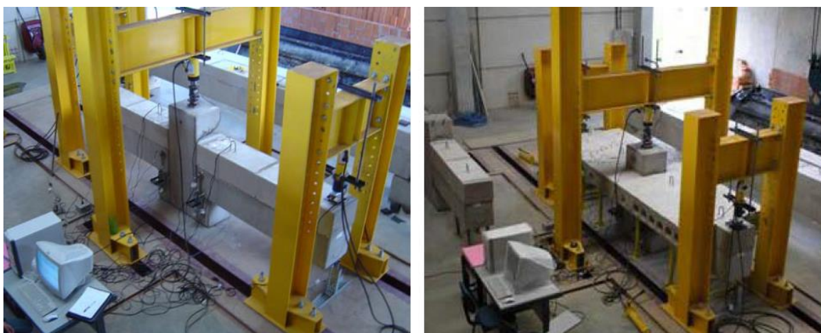
FIGURA 6.4 – Modelos de ligações viga-pilar ensaiados em Kataoka (2007)
