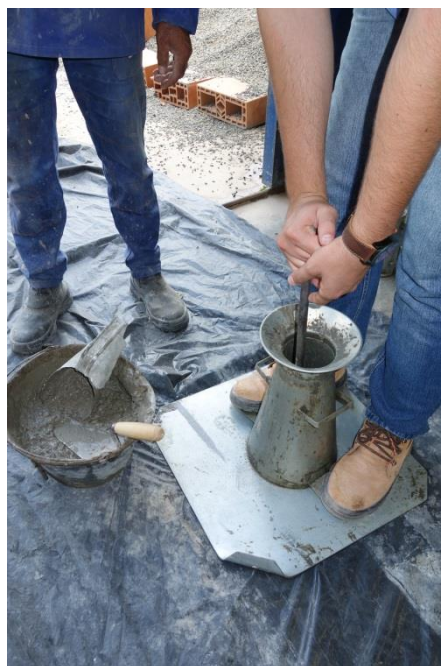
FIGURA 3.19 – Ensaio do abatimento de tronco de cone para o concreto destinado à complementação das pré-vigas moldadas no local
