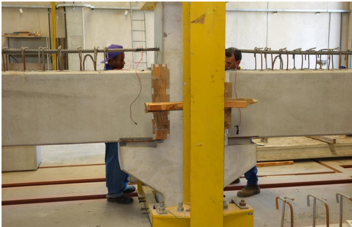
FIGURA 3.14 – Montagem do modelo chapa soldada sem estribos na zona de ligação
