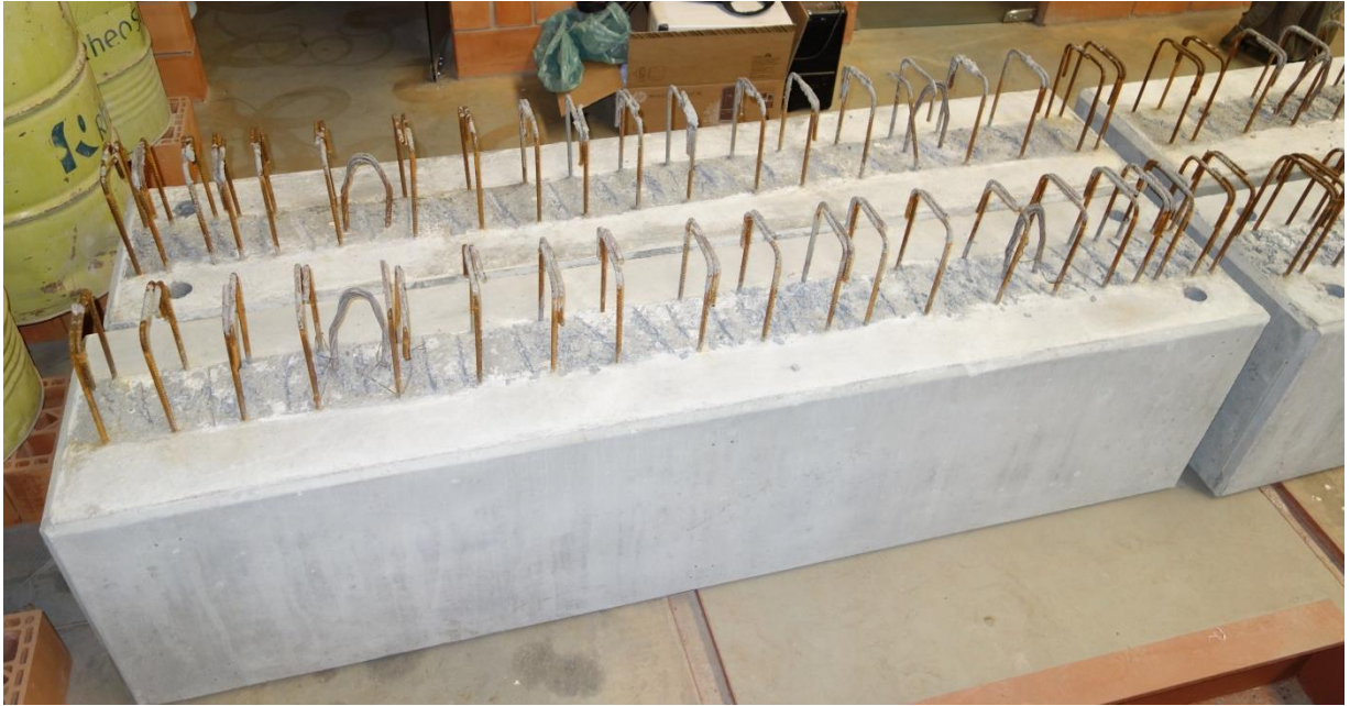
FIGURA 3.14 – Montagem do modelo chapa soldada sem estribos na zona de ligação
