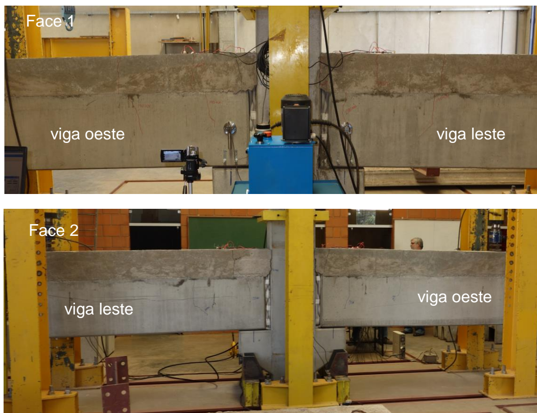
FIGURA 4.8 – Modelo deformado após o ensaio – NCE
