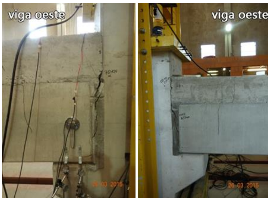
FIGURA 4.32 – Parte do modelo deformado GC após o ensaio de flexão
