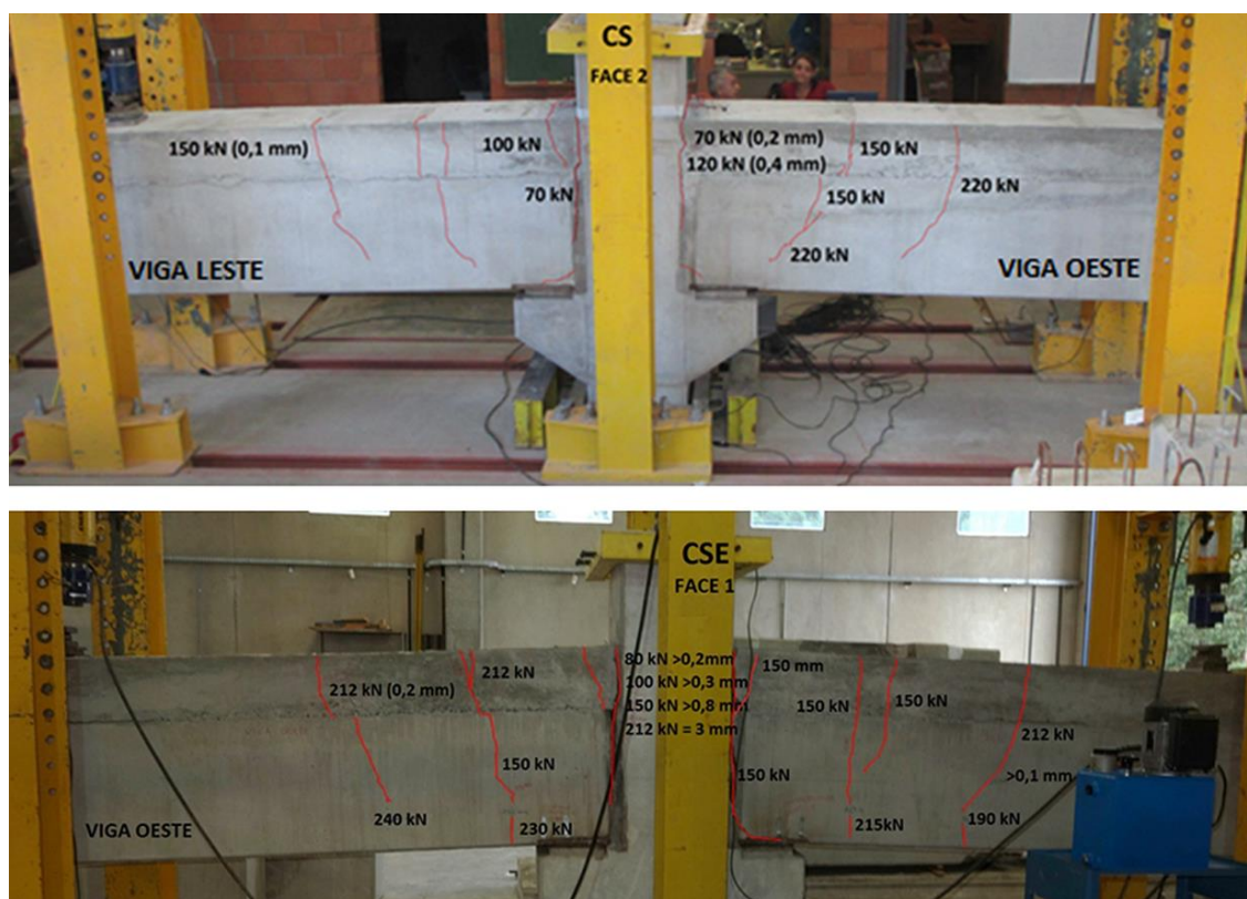
FIGURA 5.10 – Padrão de fissuras para os modelos CSE e CS
