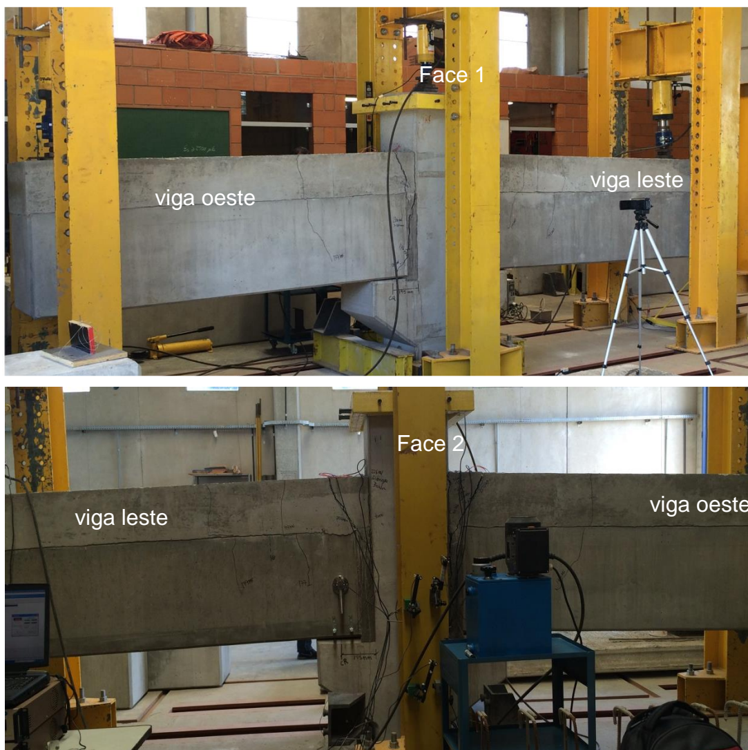
FIGURA 4.16 – Modelo NC deformado, após o ensaio de flexão
