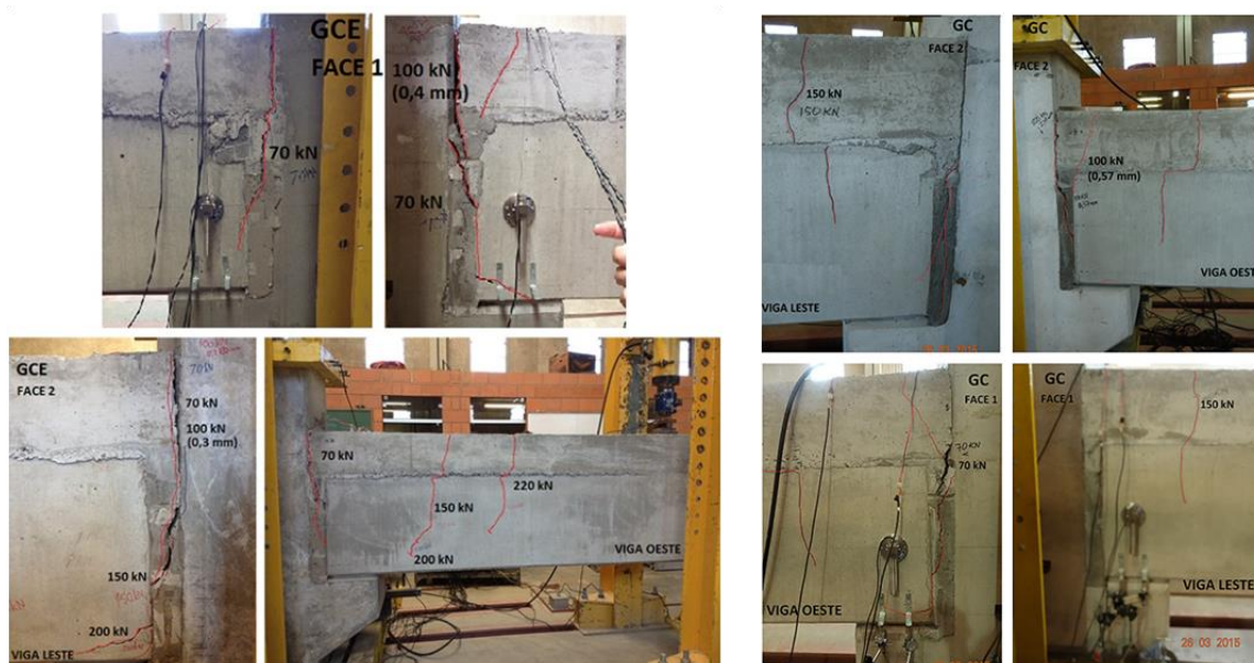
FIGURA 5.10 – Padrão de fissuras para os modelos CSE e CS
